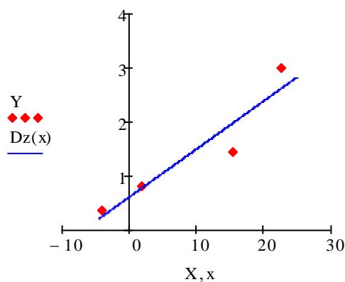
Це графік визначення поправок до показань в залежності від різниці температур вимірюваного об'єкта і навколошнього середовища.
